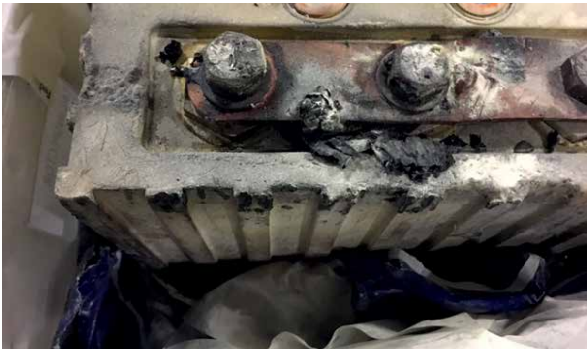
Incendie provoqué par une batterie au lithium dans un envoi postal
