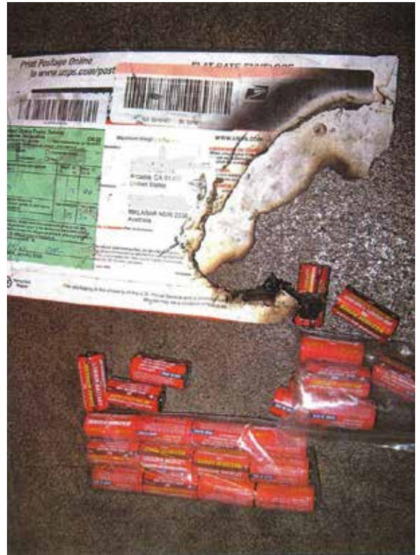
Durch Lithiumbatterien verursachter Schaden (Bild: USPS)
